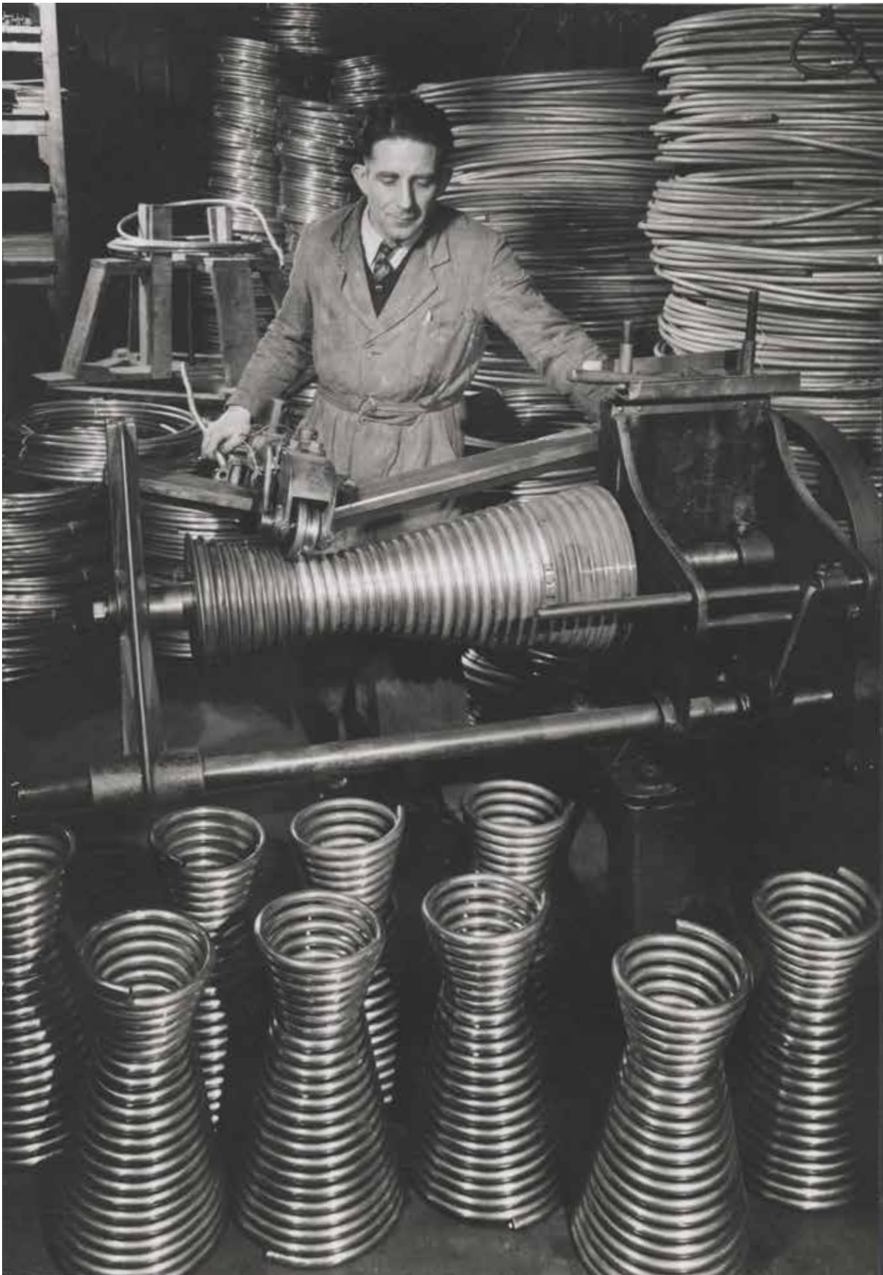
Sans titre [Fabrication de corps de chauffe de chauffe-eau, usine Brandt, France], années 1950 Donation François Kollar, Médiathèque de l'architecture et du patrimoine
