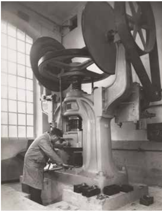
Sans titre [Emboutissage des couverts, usine Christoffle], 1950 Donation François Kollar, Médiathèque de l'architecture et du patrimoine
