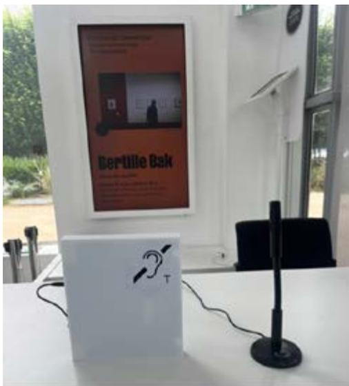
**Image 10** : Boucle à Induction Magnétique
